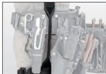
腰道具の上を通るベルトが細幅仕様になっているので、腰道具の隙間にベルトを逃がすことができます
